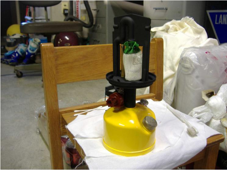
ラスト掛け後、耐熱塗料で塗装したバーナー部とヒートシールドを取付ける。燃料を入れポンピングを行いマントルを取付けて点灯準備完了。(マントルは自宅に沢山ストックしている#21を仮にいれてみた)
