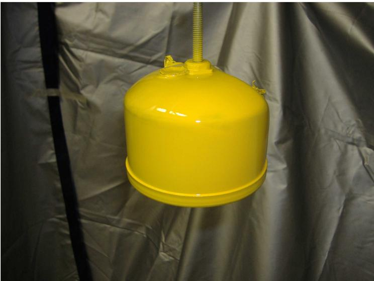
タンクをサンドブラストに掛けにプラサフを塗装後に黄色に塗装する。バーナー部とヒートシールド及びグローブもサンドブラスト掛け。グローブはスリガラス状にする。
